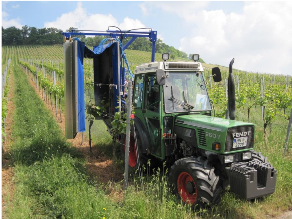
Abbildung 6: Tunnelspritzgerät der LVWO Weinsberg für die Pflanzenschutzversuche
