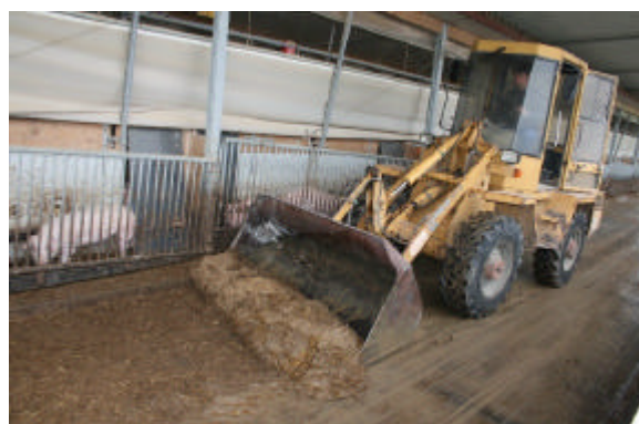
Betrieb 2: Die mobile Entmistung mit zum Beispiel einem Radlader oder Schlepper schneidet von den Kosten und der Arbeitszeit am besten ab
